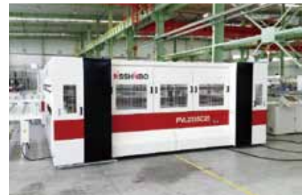
電気式インターロックカバーで安全性を確保した最新鋭ラミネータ
