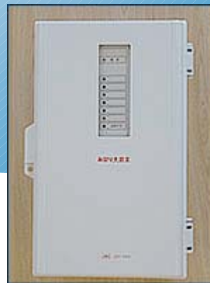
自動通報装置 / 双方向デジタル伝送装置
