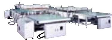
太陽電池生産設備「ラミネータ」
