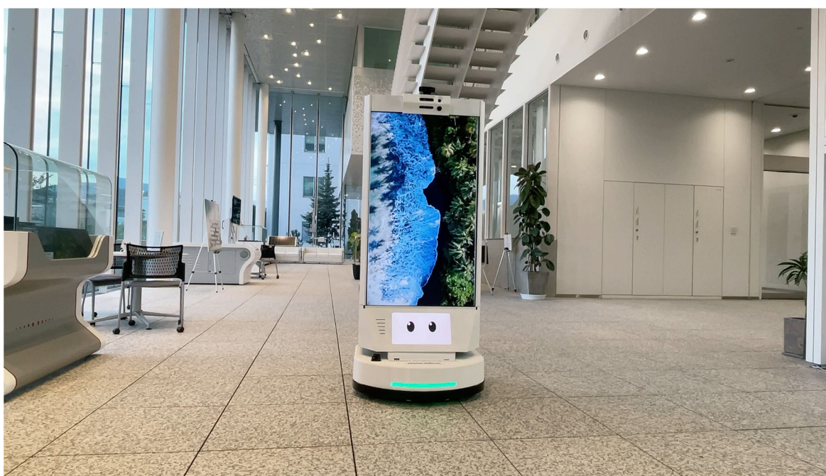
ローカル5G通信により高精細動画を受信し、ディスプレイに表示している自走式デジタルサイネージロボット ハードウェア：株式会社スマートロボティクス製
