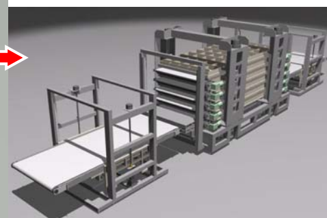
多段式モジュールラミネータを使ったライン構成
