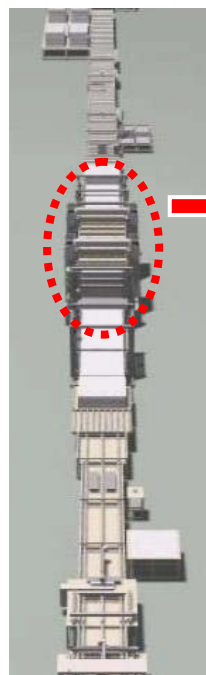
多段式モジュールラミネータを使ったライン構成
